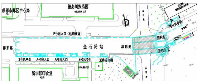
图1 新建金石路站总平面布置
